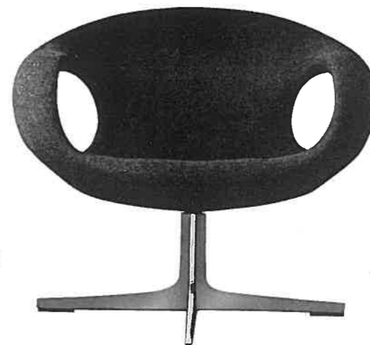
発泡性スチレン樹脂と、FRPのハニカム構造の本体にフォームラバーをのせ、布で張りくるんだイス 坂倉建築研究所のデザイン、天童木工製/ロビーイス
