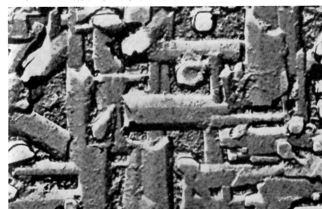
12 不明瞭円筒の組合せレリーフ——ブリキ(錫メッキ)〔同前：安藤卓雄，有賀慶司，写〕ブリキ表面の約20,000倍の拡大。抽象レリーフ彫刻のパターン。
