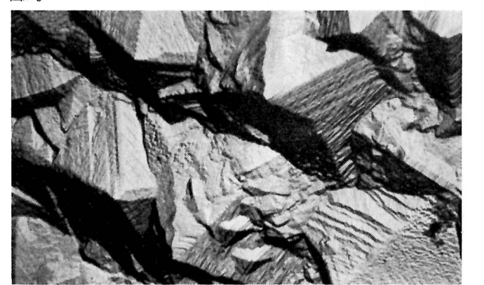
14 粗面のシャープな凹凸——ニッケル面に電着させた炭素の転写〔同前1965年：M. Froment 写〕それは炭坑の壁のようにも見えるが、こういう壁面デザインを実現させるためには、はたしてどんな材料で、どう加工して施工したらよいか——など考えることは楽しい。
