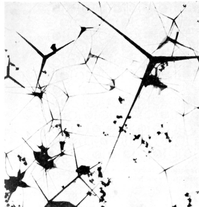
9 白地に黒の針状放射組合せ——亜鉛を焼いた煙〔同前：1961年〕つまり亜鉛華 ZnO であるが、工業用のものより微細構造は美しく、針状結晶がよく出来ているものである。図案として、この細い針のとがりかたが、なんとも美しく、また薄くすけてみえる部分との調和もよく、これを墨絵で描くとしたら、どんな筆を使ったらいいのだろう。
