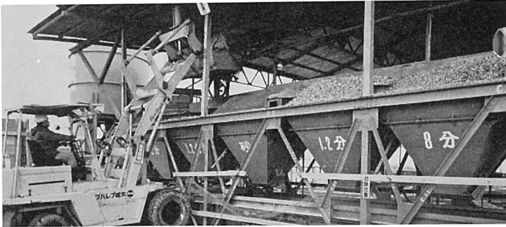
プラント附属のコンクリート 混練設備簡単なバッチャー プラントが設けられてい る。粗い砂利が使える。
